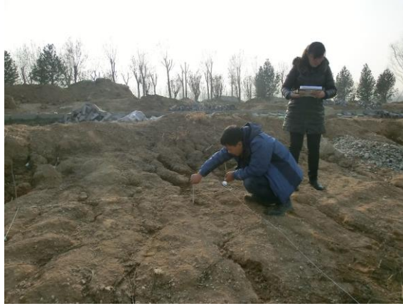
图2.2-2侵蚀沟量测法
