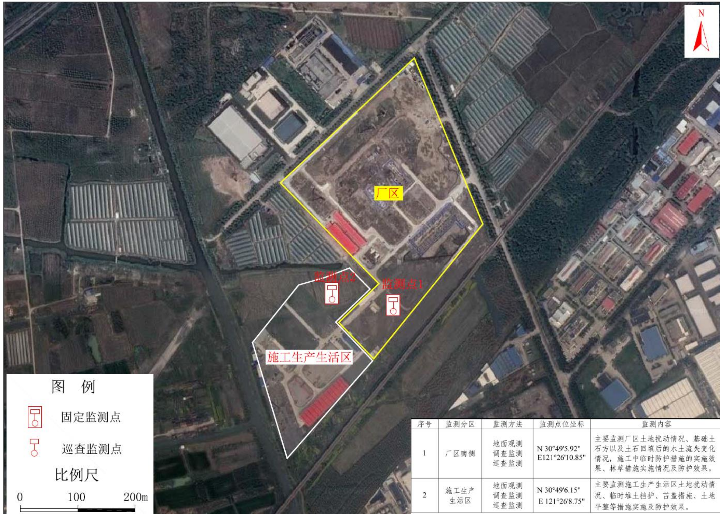
附图 2 (1) 主厂区监测分区及监测点布设图
