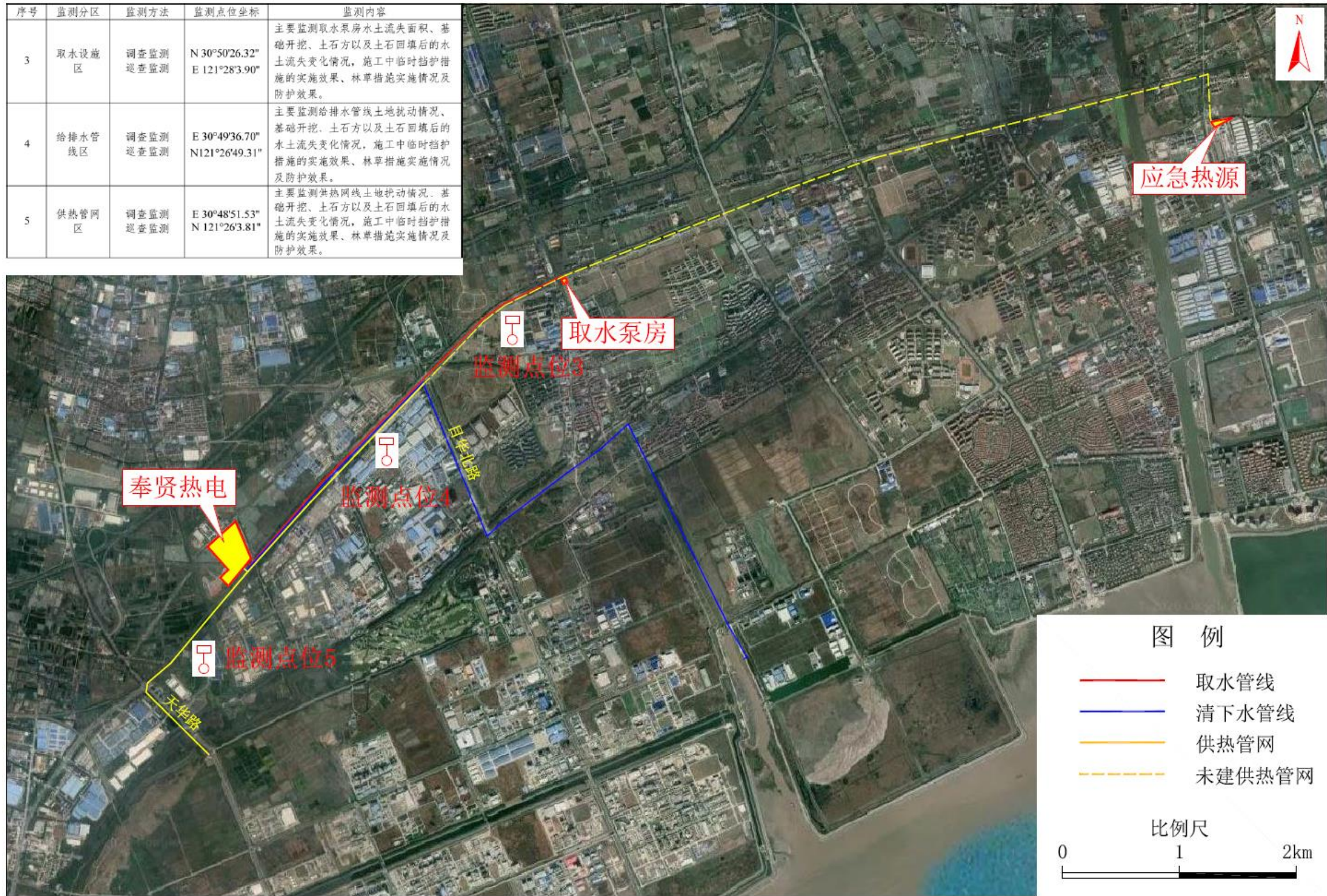
附图 2 (2) 站外管线监测分区及监测点布设图
